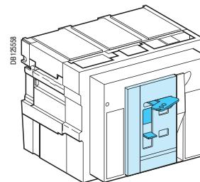
**Короткозамыкатель-заземлитель (вид сзади)**
