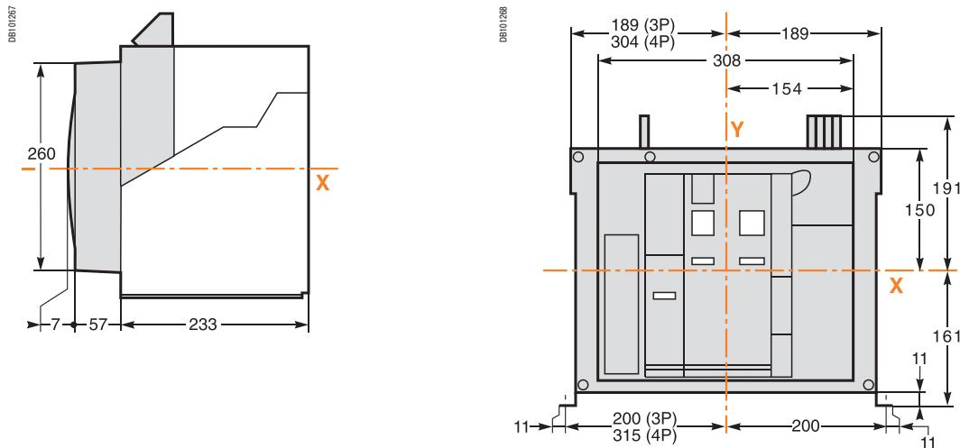
**Крепление на плате или на металлоконструкции**
