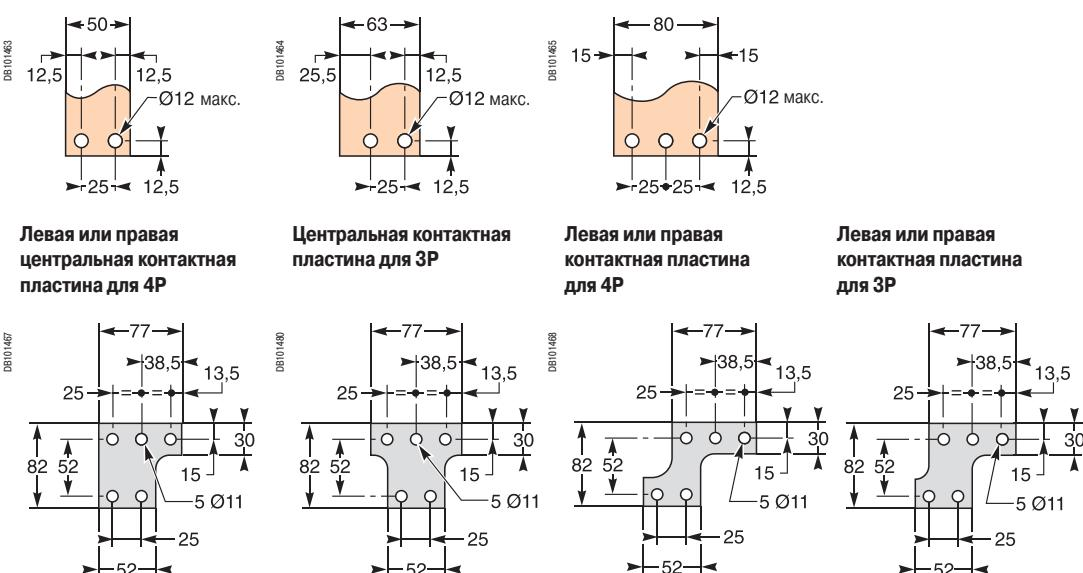
**Заднее присоединение, вертикальные контактные пластины**
