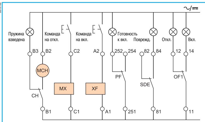
Схема электромеханического управления «шина»
