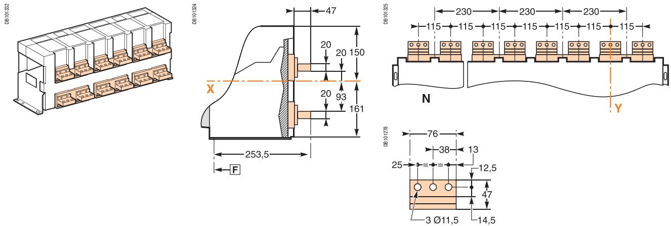
**Заднее присоединение, вертикальные контактные пластины (NW40b - NW50)**
