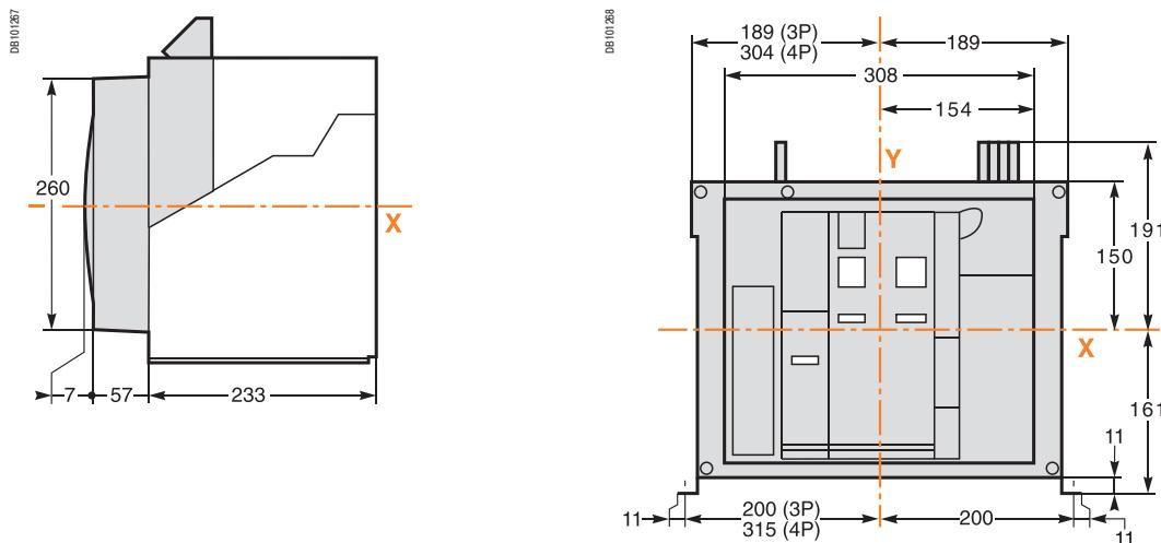
**Крепление на плате или на металлоконструкции**
