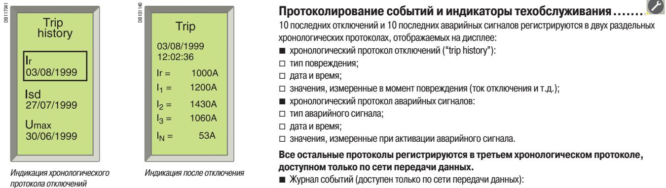
Индикация хронологического протокола отключений
