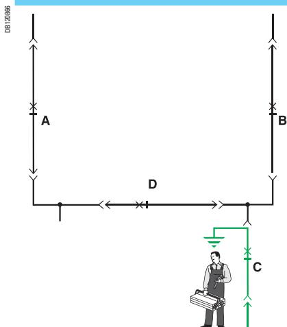
При выполнении работ на отходящей линии **C**, короткозамыкатель-заземлитель (установленный вместо автоматического выключателя **C**), входные клеммы которого соединены с землёй, обеспечивает полную безопасность, даже если все остальные аппараты электроустановки включены.
