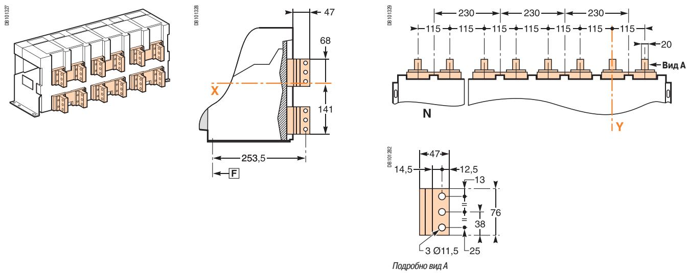
**Заднее присоединение, вертикальные контактные пластины (NW63)**
