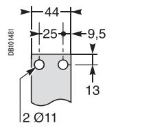
**Переднее вертикальное присоединение с пластинами-переходниками**
