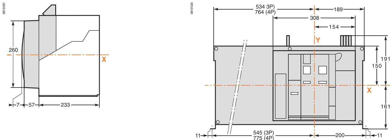
**Крепление на плате или на металлоконструкции**
