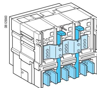
С короткозамыкающей перемычкой на нижних соединениях
